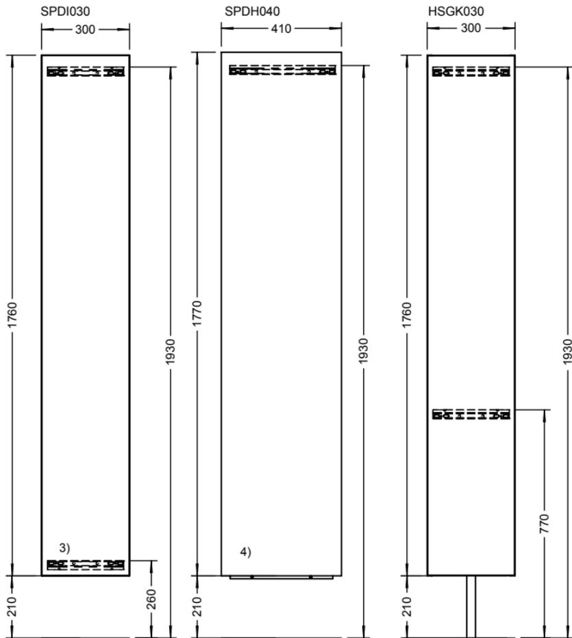
3) Montageschiene muss gedreht montiert werden
