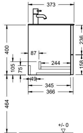
SFHR045 R \*Bei Ausführung rechts Eckventile nach rechts versetzt
